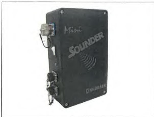
รูปที่ 11 เครื่องหยั่งน้ำ SBES “Knudsen Mini Sounder”
