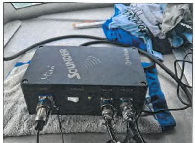
รูปที่ 11 เครื่องหยั่งน้ำ SBES “Knudsen Mini Sounder”
