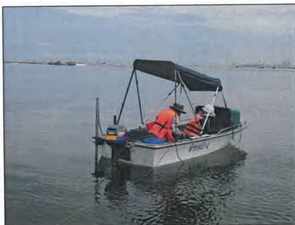
รูปที่ 17 สำรวจค่าระดับพื้นท้องน้ำด้วย ECHO SOUNDING
