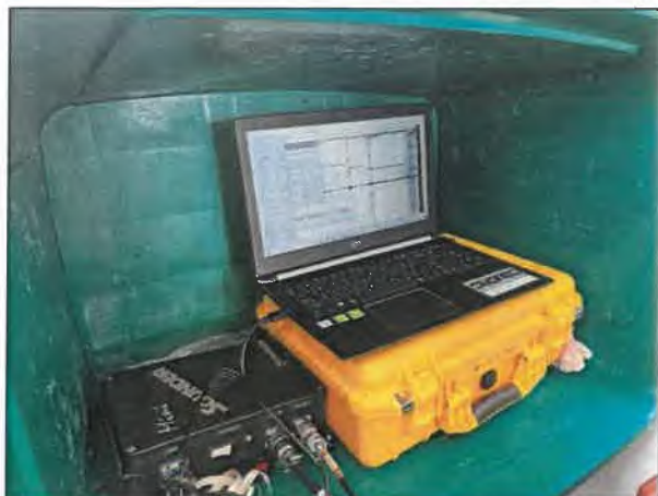
รูปที่ 17 สํารวจค่าระดับพื้นท้องน้ำด้วย ECHO SOUNDING (ต่อ)
