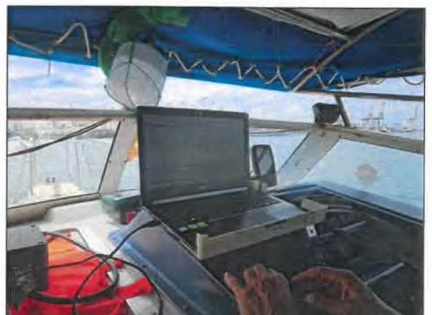
รูปที่ 41 ต่อพ่วงอุปกรณ์ GPS และ ECHO SOUNDER เข้ากับ COMPUTER
